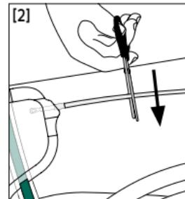
Crijevo škarama skratite na željenu duljinu (lijevo: kosi rez kod krutog crijeva, desno: ravni rez kod mekog crijeva).
