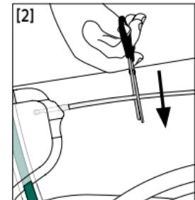
Βραχύνετε τον σωλήνα στο επιθυμητό μήκος με ένα ψαλίδι (αριστερά: λοξή τομή για δύσκαμπτο σωλήνα, δεξιά: ευθεία τομή για εύκαμπτο σωλήνα).
