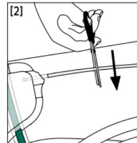
Vágja le a csövet egy ollóval a kívánt hosszúságra (bal: ferde vágás kemény cső esetén, jobb: egyenes vágás puha cső esetén).
