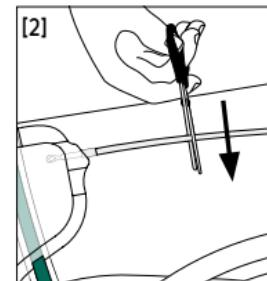
Скъсете гъвкавата тръбичка с ножица до желаната дължина (отляво: разрез под наклон при твърда тръбичка, отдясно: прав разрез при мека тръбичка).
