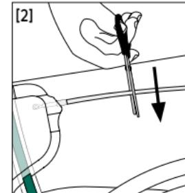
Raccourcir le flexible à la longueur souhaitée à l'aide de ciseaux (gauche : coupe en biais pour un flexible rigide, droite : coupe droite pour un flexible souple).
