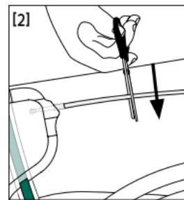
Recorte el tubo hasta obtener la longitud deseada con ayuda de unas tijeras (izquierda: corte biselado en caso de un tubo rígido, derecha: corte recto en caso de un tubo blando).
