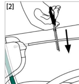
Den Schlauch mit einer Schere auf die gewünschte Länge kürzen (links: schräger Schnitt beim harten Schlauch, rechts: gerader Schnitt beim weichen Schlauch).
