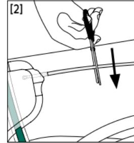
Klipp med sax av slangen till önskad längd (vänster: ett snett snitt för en hård slang, höger: ett rakt snitt för en mjuk slang).
