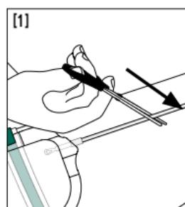
Pomocí nůžek zkrat'te hadičku na požadovanou délku (vlevo: šíkmý stříh u tvrdé hadičky, vpravo: rovný stříh u měkké hadičky).
