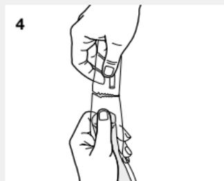
Tournez l'emballage et laissez couler l'eau dans la partie arrière de celui-ci. Détachez cette partie. Ouvrir l'emballage fonctionnel en avant en utilisant la marque de déchirement et puis, avec un coup sec, détacher l'emballage pour dégager la tête de la sonde. Si la sonde colle à l'emballage veuillez tourner la sonde et plus tirez.
